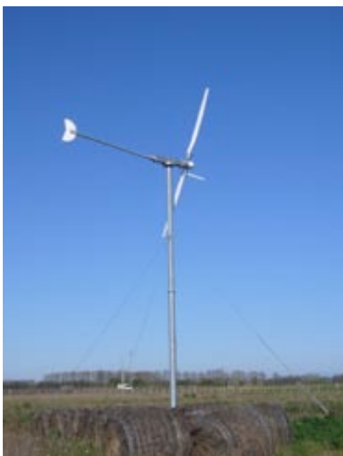
Aérogénérateur à axe horizontal à Vauvert
