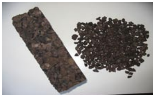
Liège expansé vrac et panneau
