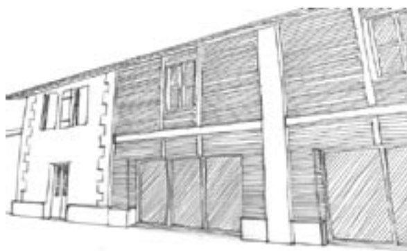
Mas du Versadou Saint-Gilles : un exemple de fermeture de parois où le bois aurait pu être mis en oeuvre pour une meilleure intégration à l'existant
